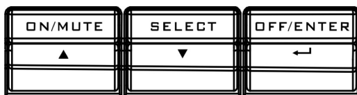
Рисунок 3 – Внешний вид кнопок управления ИБП
