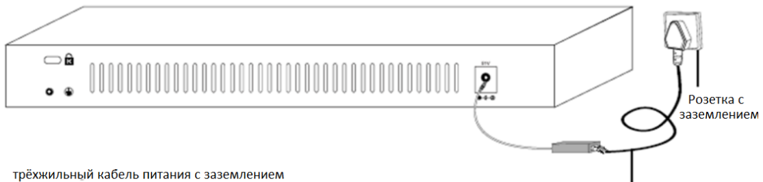
Рисунок 2.9 Заземление с использованием трехжильного кабеля питания
